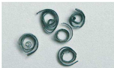
De gros copeaux à enroulement très serré ou présentant des nuances bleutées signalent une avance trop élevée
